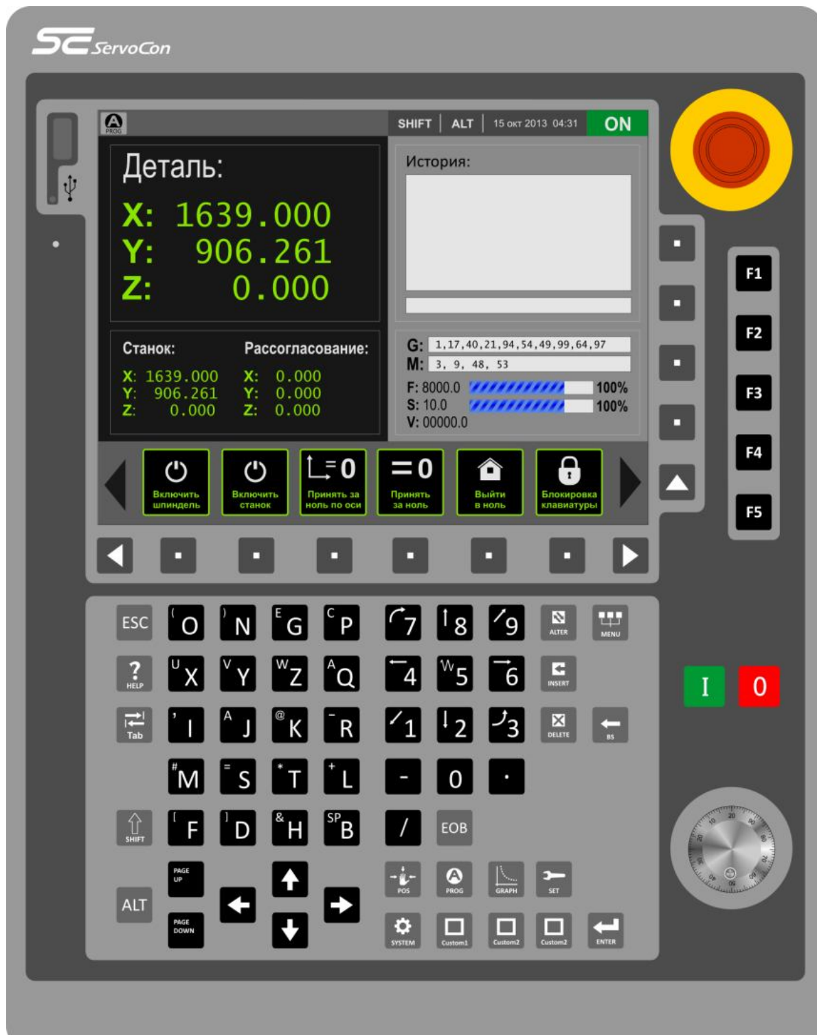
Рис. 5. Лицевая панель СЧПУ СервоКон 2000 ® .
